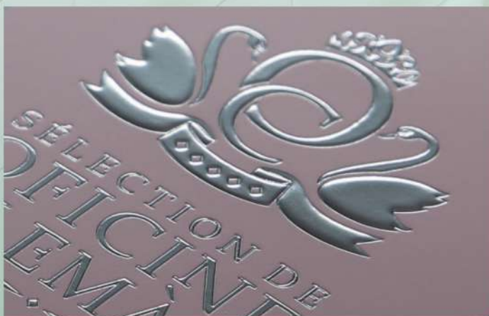
Stampa a caldo con rilievo in contemporanea
