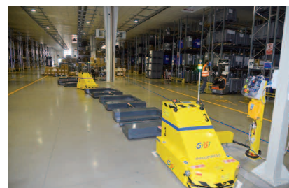
Il "trenino" robot AGV in grado di trasportare specifici materiali lungo il settore logistico dello stabilimento.
