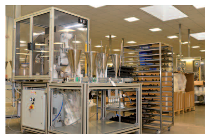
Impianto di iniezione e pressatura delle polveri cosmetiche secondo la tecnica della back injection.
